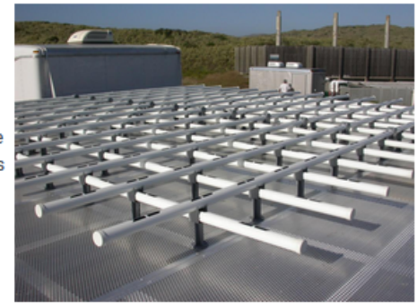
449 MHz 1/4-scale phased array wind profiler
